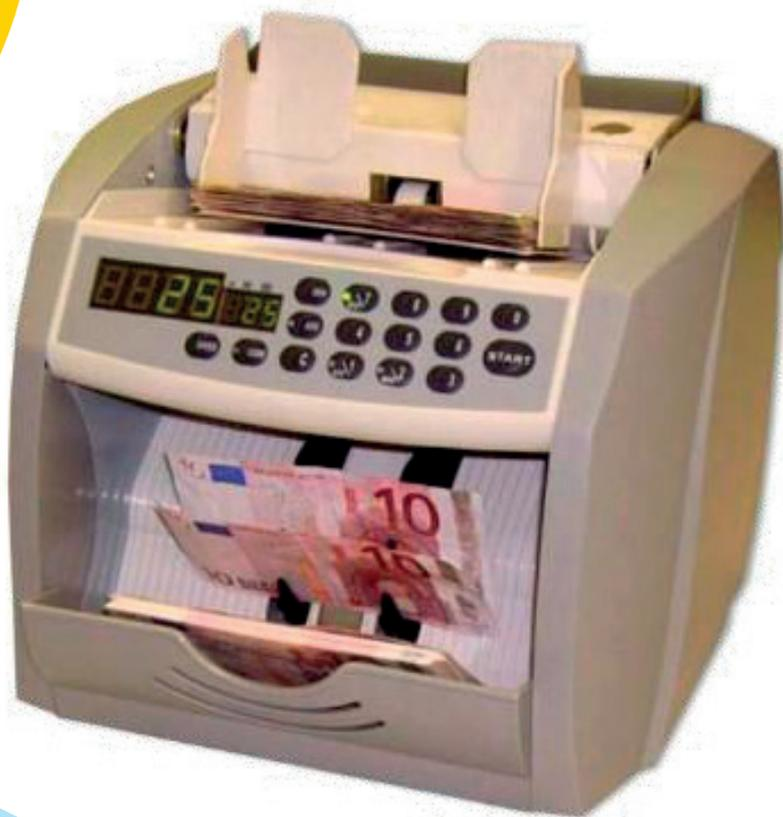
Contabanconote intelligente per il conteggio di elevati lotti di banconote. 3 velocità 200 / 900 / 600 b/n al minuto Controllo del falso UV+MG Partenza : automatica / manuale. Controllo DD Display di conteggio a 4 cifre. Display di preset a 3 cifre. Errori rilevabili : banconota concatenata, mezza, inceppamento. Capacità di carico: 300 b/n. Conteggio libero oppure da 1 a 999 con tastierino. Dimensioni 115 x 50 - 175 x 85
